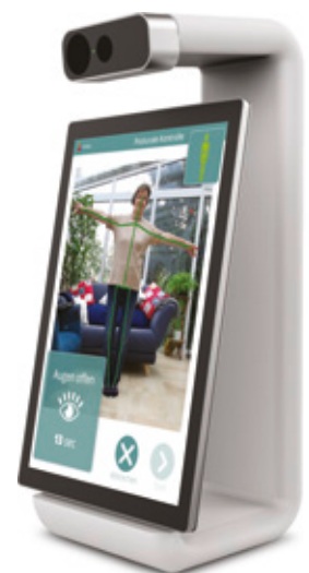
Während der Aufgaben werden Ganzkörperbewegungsdaten in 3D aufgezeichnet und anschließend auf dem Gerät analysiert.
